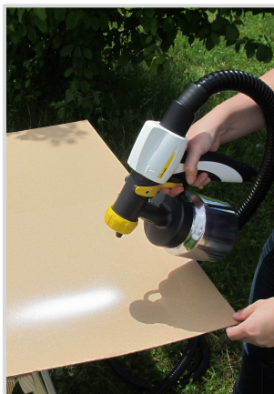
verticale verfstraal voor werken van rechts naar links
