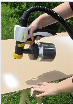
horizontale verfstraal voor werken van boven naar beneden
