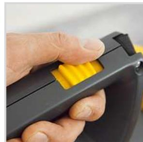
9. Empezar por las esquinas, los bordes y los ángulos y pulverizar después en las superficies. Empezando desde el exterior, vaya aplicando la pintura a una distancia uniforme hasta sobrepasar la puerta. Cambie la dirección de pulverizado solo una vez que esté fuera de la superficie de la puerta. Así evita que se formen capas de laca más gruesas al cambiar de dirección.
