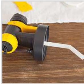
6. Llene el depósito a 3/4 con laca y dilúyala. Coloque el agitador en el fondo del depósito de pintura lleno. La distancia entre las muescas representa una dilución del 10%. En todos los botes de laca de distintos fabricantes marcados con "Perfect Spray" figuran indicaciones para la dilución.
