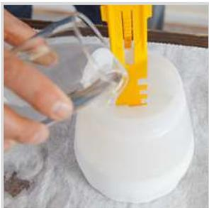
7. Remueva vigorosamente la pintura y realice una prueba de pulverización. Dado que se utiliza laca, coloque el conmutador en el nivel 2. Para barnices líquidos sería correcto elegir el nivel 1.
