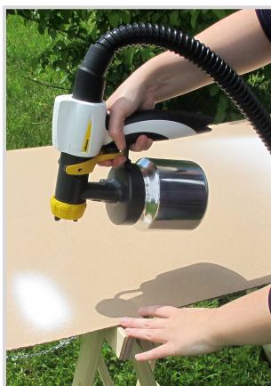
Chorro de pintura horizontal para trabajar desde arriba hacia abajo
